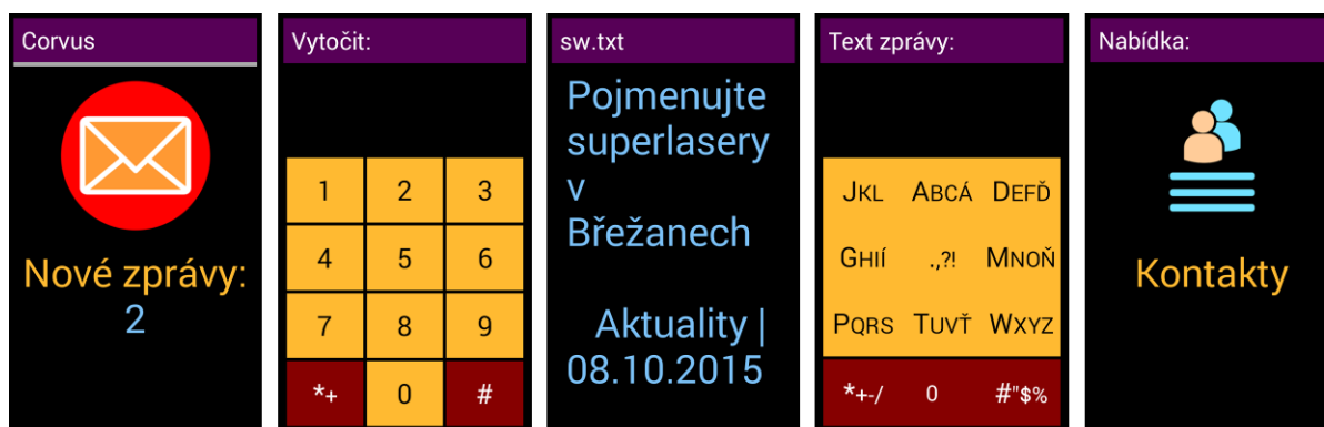
Obr.2: 5 screenshotov programu CORVUS – postupne zľava: 1. informácia o novo doručených správach, 2. numerická tlačidlová klávesnica na vytáčanie tel. čísla, 3. otvorený textový dokument v čítačke kníh, 4 špeciálna kresliaca klávesnica, 5. Ponuka - Kontakty
